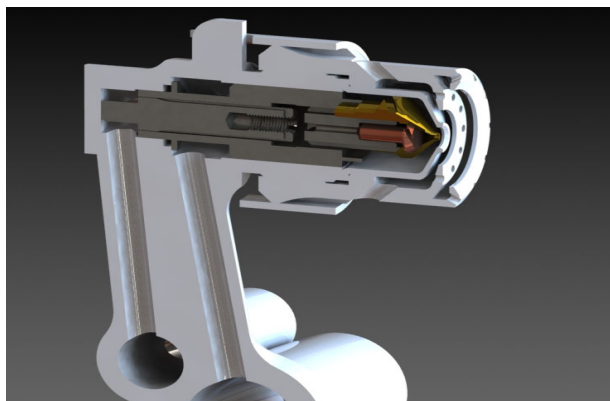
Рис. 5. Комп'ютерна модель паливної форсунки колектору АЛ-31Ф
