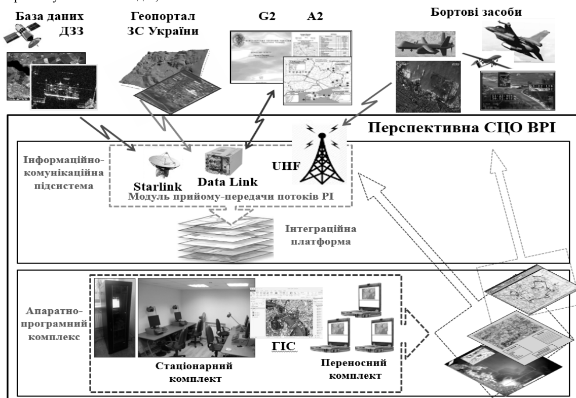
Рис. 2. Функціональна схема перспективної уніфікованої СЦО ВРІ
