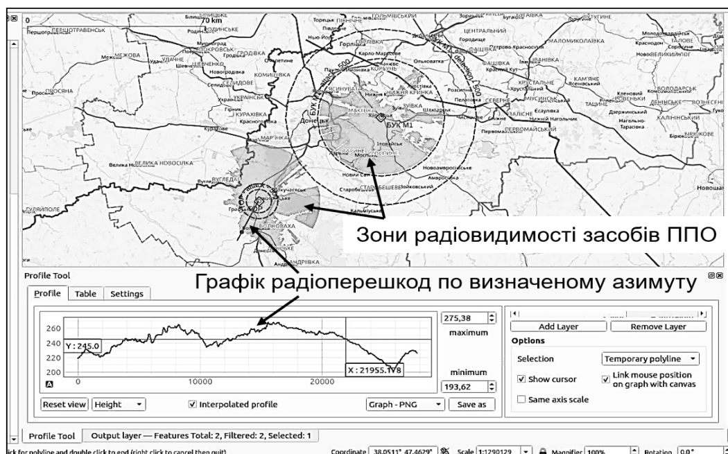
Рис. 10. Візуалізація за допомогою ПЗ QGIS зон прямої радіолокаційної видимості РЛС ЗРК з урахуванням оточуючого рельєфу місцевості Джерело: розроблено авторами
