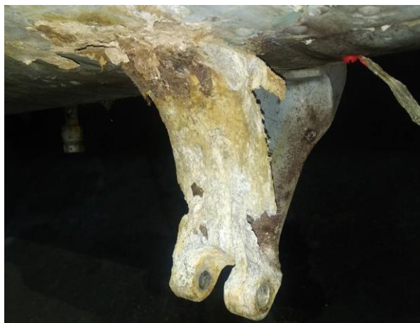
Рис. 6. Корозійне ураження кронштейна кріплення підвісного паливного бака вертольота Ми-8.
