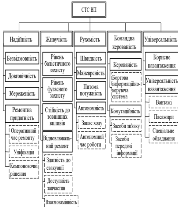
Рис. 2. Функціонально-морфологічна декомпозиція СТС ВП.
