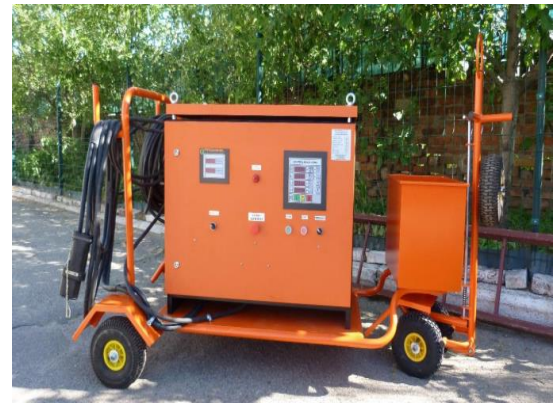
Рис. 10. Перетворювач частоти ПЧ-ТТП- 95-200-400-УХЛ з додатковим виходом 1800 А, 28 В. Джерело [6].
