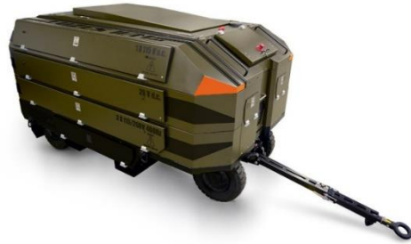
Рис. 4. Автономне джерело живлення літаків LUZES-IIM серія VI. Джерело: [5].
