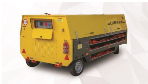
Рис. 2 Автономне джерело живлення літаків LUZES V/N серія III. Джерело [5].
