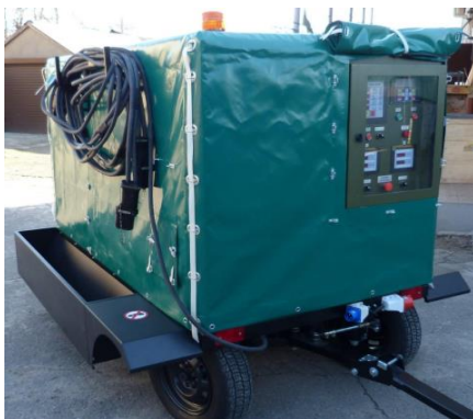
Рис. 7. Джерело живлення автономне аеродромне пересувне АПДЖ-45/1800-1. Джерело [6].
