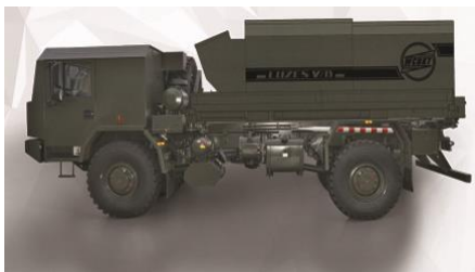
Рис. 1. Автономне джерело живлення літаків LUZES V/D серія V. Джерело [5].
