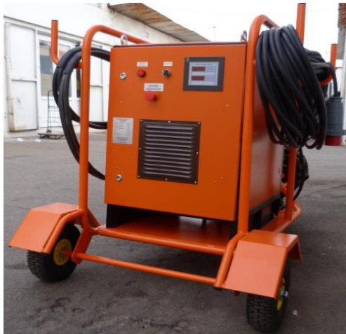
Рис. 9. Випрямляч аеродромний інверторний ВАІ-1500/28. Джерело [6].
