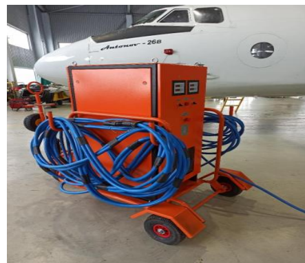
Рис. 8. Випрямляч аеродромний інверторний BAI-2400/28/2. Джерело [6].
