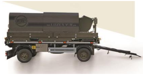
Рис. 3. Автономне джерело живлення літаків LUZES-V/N серія IV. Джерело: [5].
