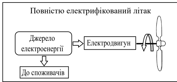
Рис. 2. Функціональна схема ПЕЛ з електричним двигуном.
