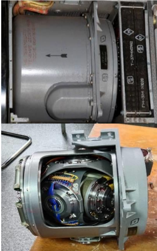
Рис. 15. Інерціальна гіроскопічна платформа ПГИ-2М. Джерело: [12, с. 56].
