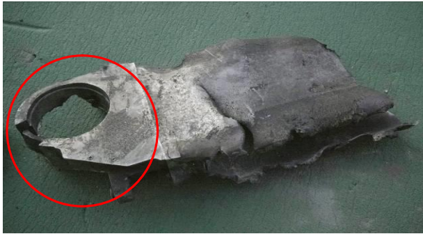
Рис. 9. Зовнішній вигляд фрагментів несучих висувних аеродинамічних поверхонь ракети Х-101. Джерело: [12, с. 52].
