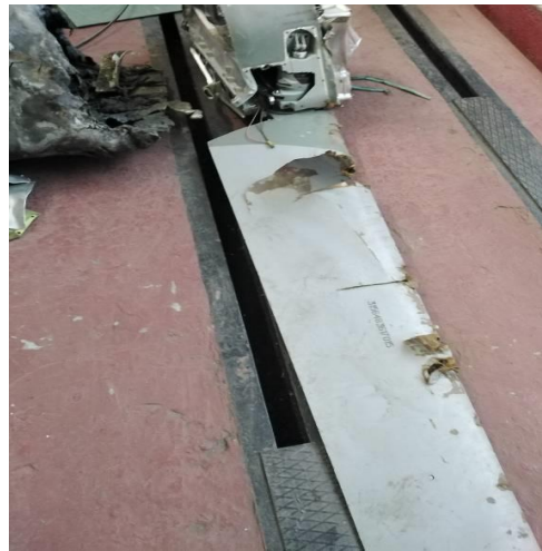
Рис. 13. Зовнішній вигляд крила, що розкладається. Джерело: [12, с. 54].
