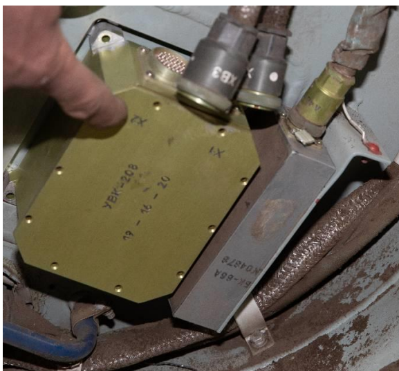
Рис. 16. Показчик висоти кодовий УВК-208. Джерело: [12, с. 57].
