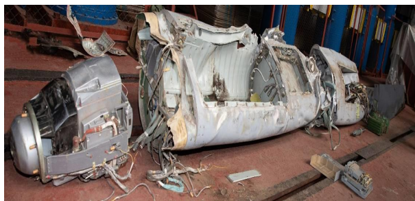
Рис. 5. Залишки ракети Х-101.
