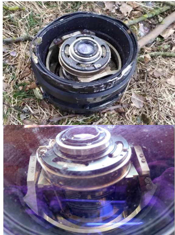
Рис. 17. Електронно-оптична кореляційна система “Отблеск” ИРЦУ.468173.008 з оптико-механічним блоком. Джерело: [12, с. 58].
