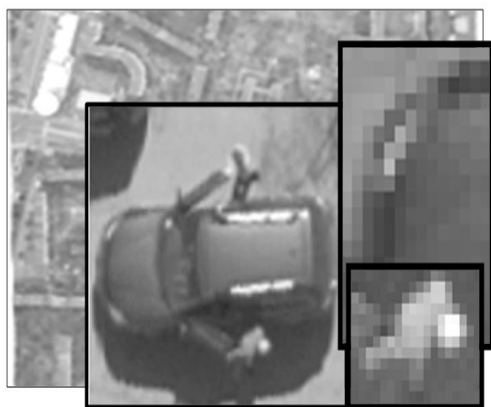
Рис. 3. Результати аерознімання типових цілей повітряного спостереження літаком Ан-30Б з комплексом 3-DAS-1. Джерело: [21, Додаток].
