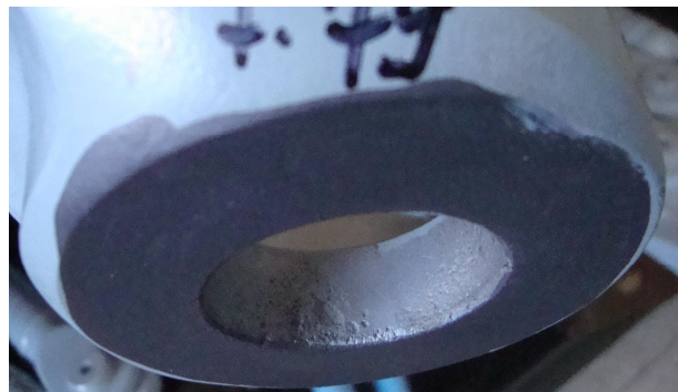
Рис. 6. Місце корозійного ураження вузла-п'ятки підкоса підредукторної рами після усунення корозії та антикорозійної обробки.
