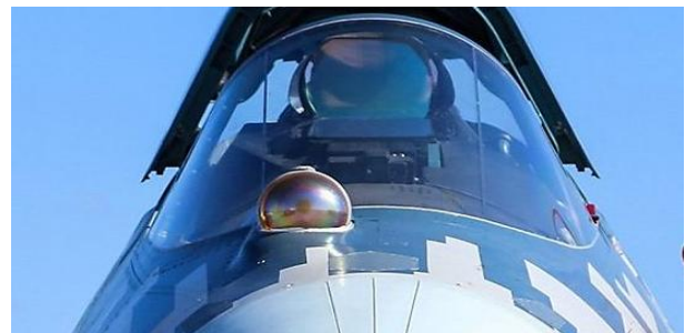
Рис. 2. Оптико-локаційна станція літака типу Су-57. Джерело: [11].
