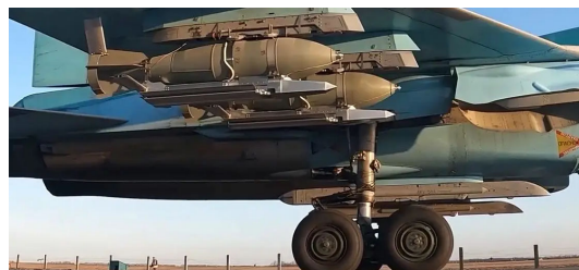
Рис. 8. Су-34 вск рф з підвішеними ФАБ-500М62 з модулями УМПК. Джерело: [14]
