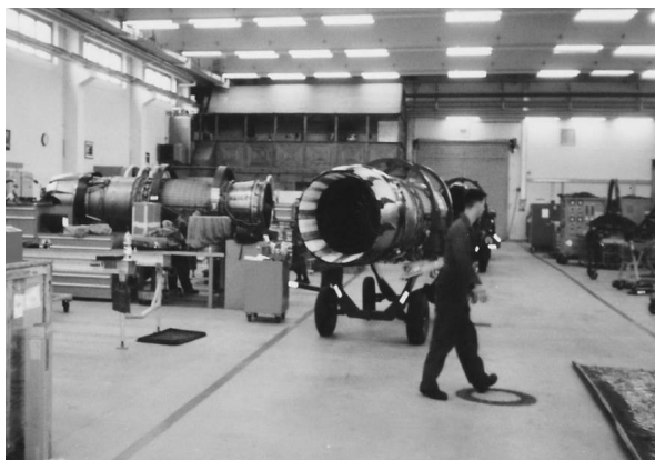
Рис. 3. Цех перебирання авіаційних двигунів (Деро) авіабази Повітряних Сил США в Шпангдалемі Джерело: фото авторів
