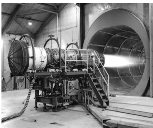
Рис. 4. ГТД F100-PW-129 на випробувальному стенді Джерело: [14, с. 70]
