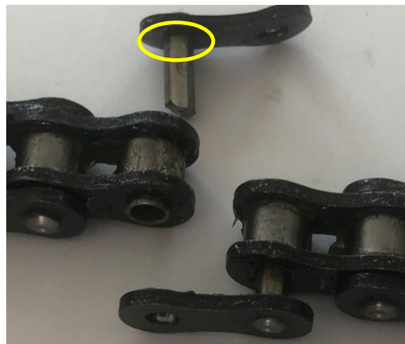
Рис. 2. Загальний вигляд фрагментів ланцюга після випробування його на розрив Джерело: розроблено авторами
