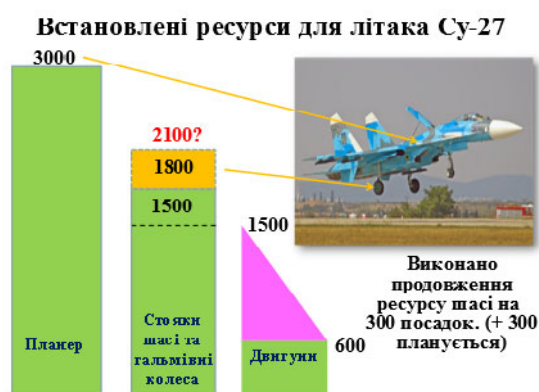
Рис. 1. Комплекуючі агрегати ЛА, що мають ресурс відмінний від ресурсу планера Джерело: розроблено авторами
