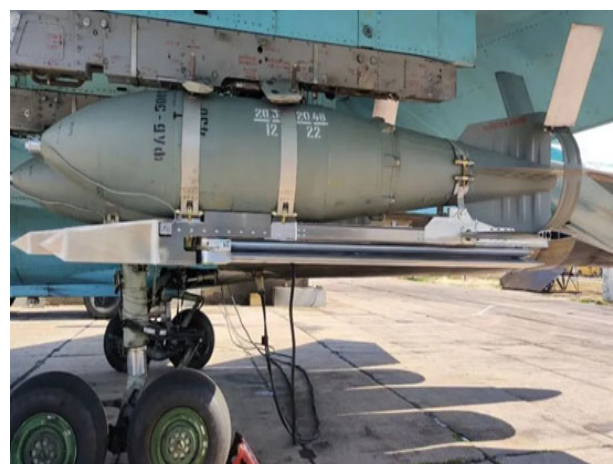
Рис. 1. Авіаційна бомба ФАБ-500М-62 з універсальним модулем планування та корекції Джерело: [2]
