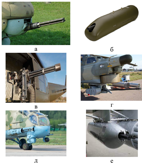
Рис. 1. Види та варіанти розміщення на вертольотах артилерійського (стрілецького) озброєння Джерело: розроблено авторами за матеріалами [3...7]
