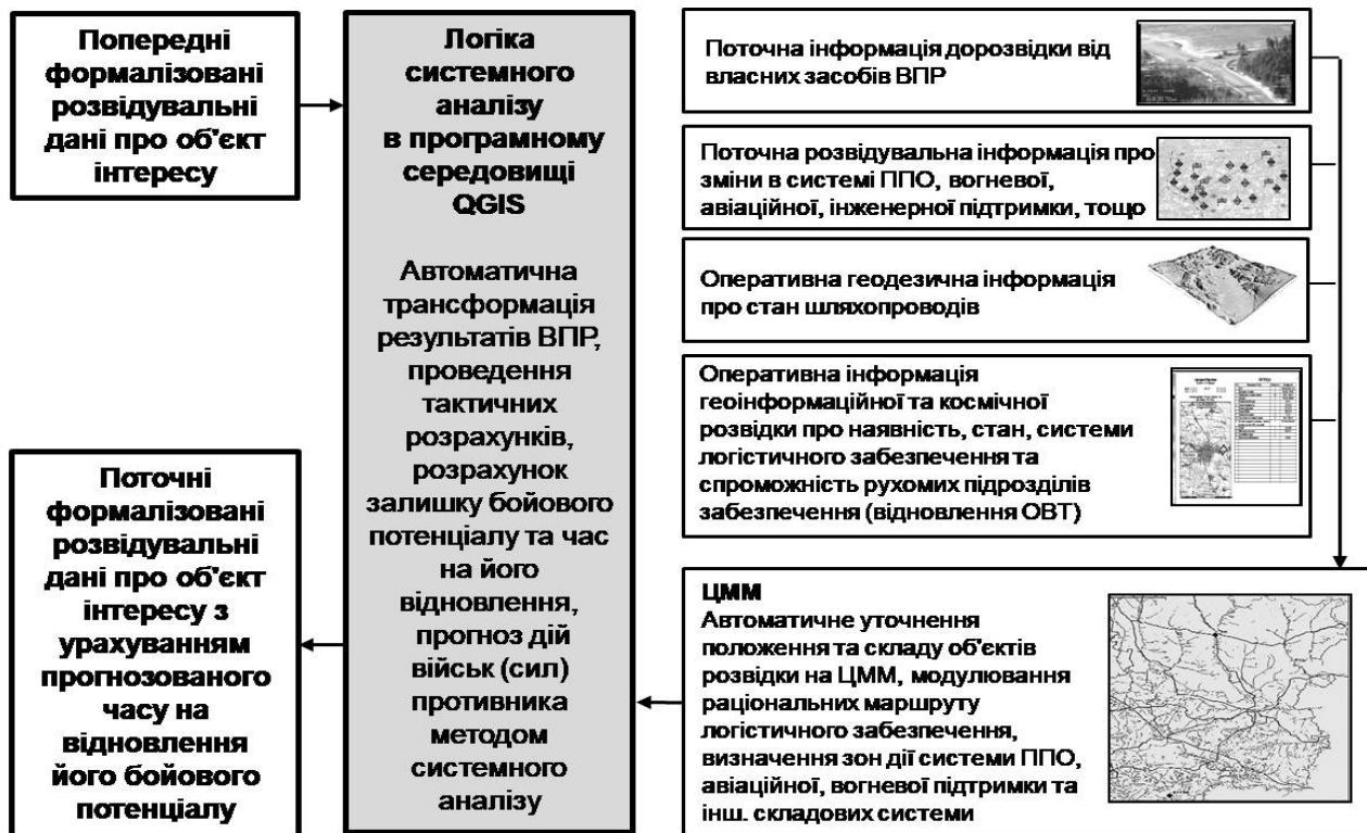
Рис. 8. Варіант логіки обробки інформації ВПР за допомогою ПЗ “QGIS”
