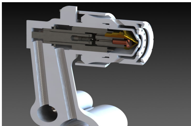
Рис. 5. Комп'ютерна модель паливної форсунки колектору АЛ-31Ф
