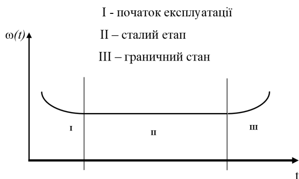
Рис. 4. Типова якісна залежність параметра потоку відмов \omega(t) від часу експлуатації Джерело: розроблено за матеріалами [6]
