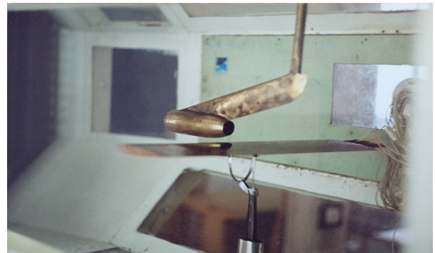
Рис. 1. Фрагмент експериментальної установки для вимірювання розподілу тиску на поверхні крила Джерело: розроблено авторами
