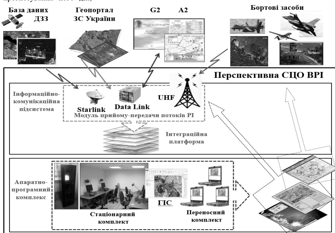
Рис. 2. Функціональна схема перспективної уніфікованої СЦО ВРІ
