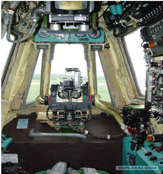
Рис. 4. Кабіна бортового стрілка з КПС-53А Джерело: [13]
