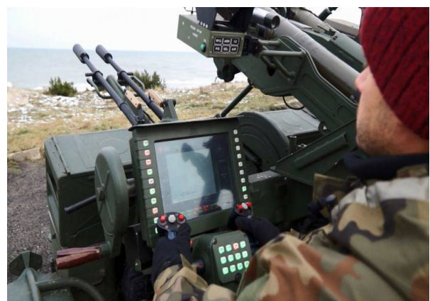
Рис. 5. Автоматизоване робоче місце оператора ЗУ-23-2 Джерело: [14]
