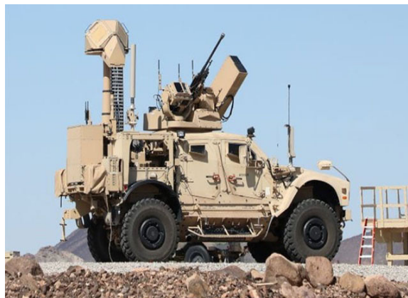
Рис. 3. Модуль R400S-Mk2 на автомобілі Хамер Джерело: [9]
